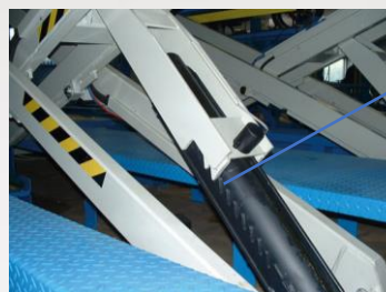
Dispositif de soutien mécanique avec enclenchement automatique et dégagement pneumatique, pour garantir la sécurité totale pendant le stationnement.
