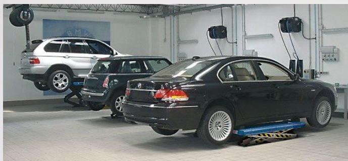
Dispositif de soutien mécanique avec enclenchement automatique et dégagement pneumatique, pour garantir la sécurité totale pendant le stationnement.
